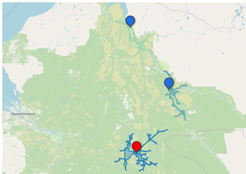
Рис. 2. Изохроны транспортной доступности (60 минут) для ряда административных центров муниципальных районов/округов северо-востока Архангельской области (фрагмент карты)
